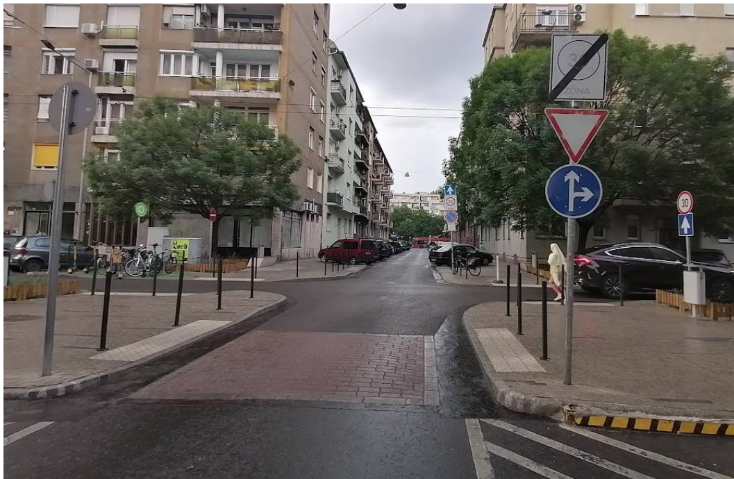
8. ábra: Kisméretű épített küszöb torkolati szűkítésben
